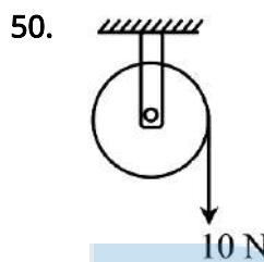
0.2 m त्रिज्या का एक पहिया अपने केंद्र के परितः स्वतंत्र रूप से घूर्णन करता है जब इसके किनारे (रिम) पर लपेटी गई एक डोरी को 10 N के बल से खींचा जाता है जैसा कि चित्र में दर्शाया गया है। उत्पन्न बलाधूर्ण  $2 \text{ rad/s}^2$  का कोणीय त्वरण उत्पन्न करता है। पहिए का जड़त्व आधूर्ण \_\_\_\_\_  $\text{kgm}^2$  है।
